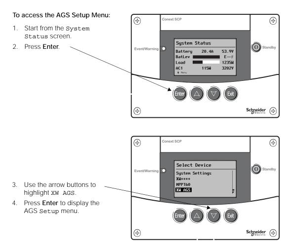
Figure 3-29 Accessing the AGS Setup Menu
